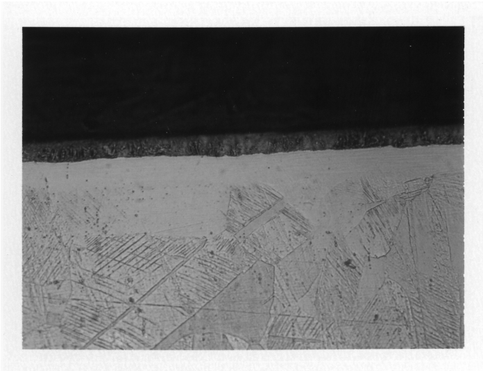
写真 1. SUS 304 PSN処理組織写真 (×400)
